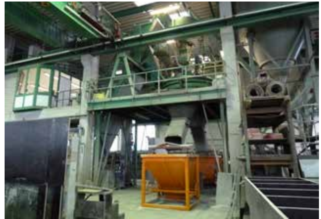
Bild 11: Übergabe des Frischbetons im Fertigteilwerk
