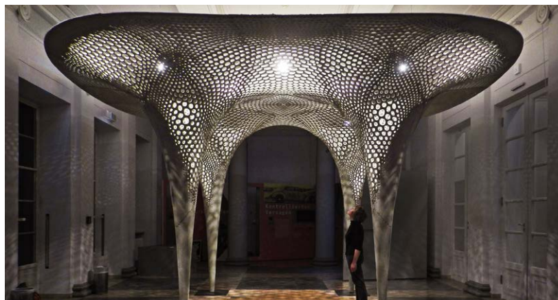
Der Rosenstein-Pavillon: Inspirationsquelle für die funktional gradierte Betonschale waren leichte und zugleich starke Strukturen in der Natur.
