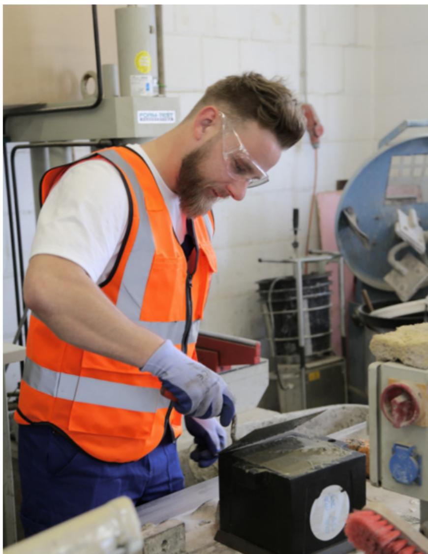
Herstellen von Probekörpern zur Prüfung der Festbetoneigenschaften | Quelle: BTB
