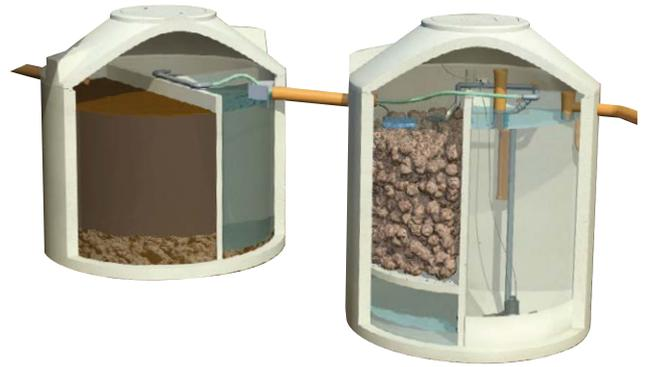
Bild 9: Tropfkörperanlage
