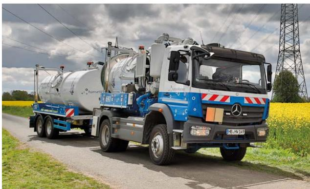
Bild 2: Saugwagen zur Entschlammung von Kleinkläranlagen
