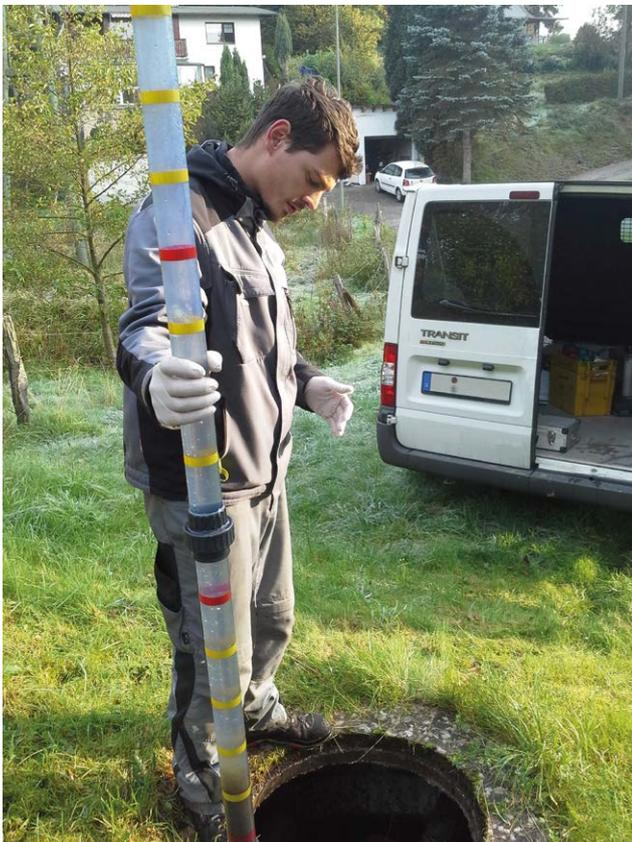
Bild 15: Schlammspiegelmessung im Rahmen der Wartung
