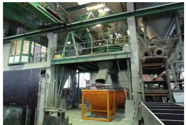
Abb. 10: Übergabe des Frischbetons im Fertigteilwerk
