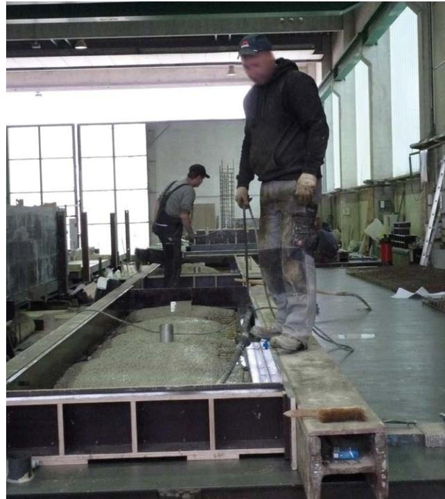
Abb. 11: Verdichten des Betons in der Schalung im Fertigteilwerk
