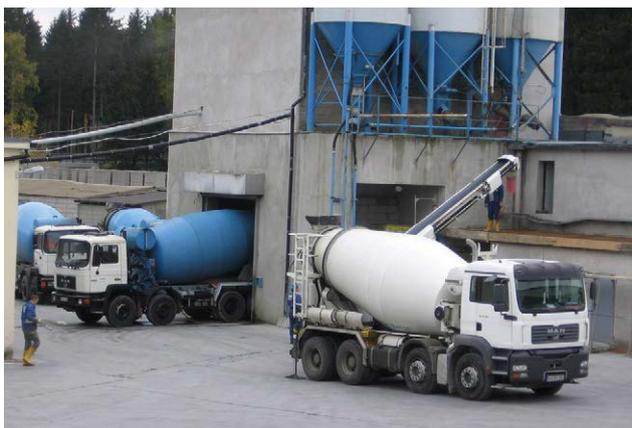
Abb. 9: Einfüllen des Frischbetons in den Fahrmischer
