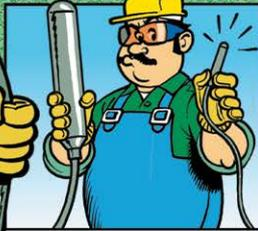
EINEN RÜTTLER MIT GEEIGNETER FREQUENZ UND DURCHMESSER VERWENDEN.
