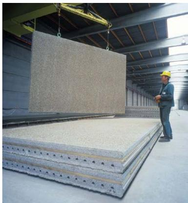
Spannbeton-Fertigdecken sind vorgefertigte Deckenelemente, die auf modernsten Produktionsanlagen hergestellt werden.
