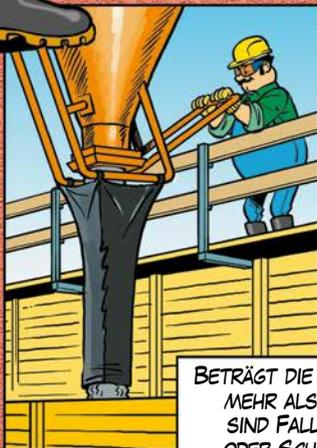
BETRÄGT DIE FALLHÖHE MEHR ALS 1,5 M, SIND FALLROHRE ODER SCHLÄUCHE ZU VERWENDEN.
