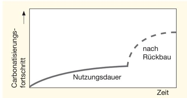
Abb. 15: Quantitativer Verlauf des Carbonatisierungsfortschritts in Beton
