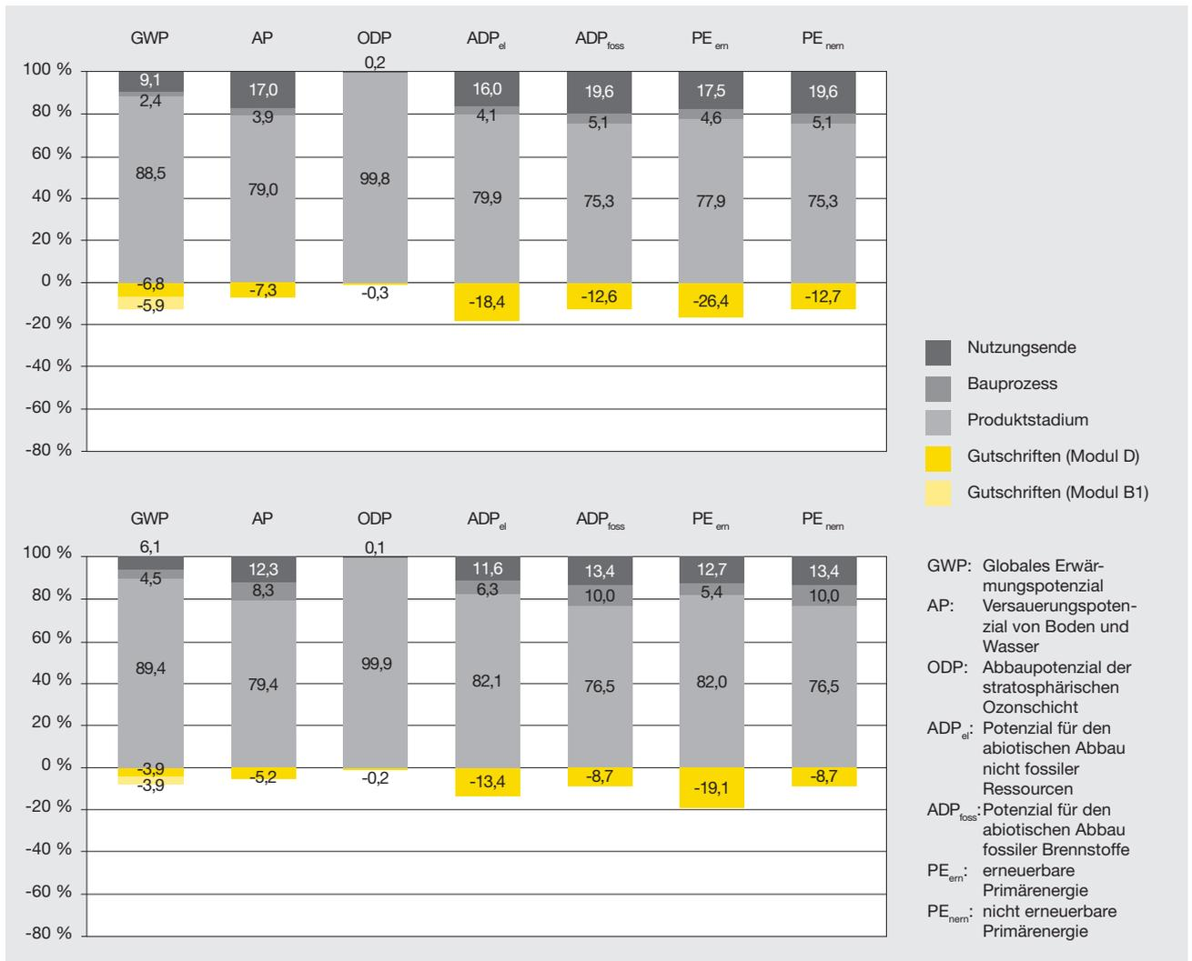
Abb. 16: Starke Dominanz der Produktherstellung in der Ökobilanz von Beton (oben: C25/30 und unten: C50/60)
