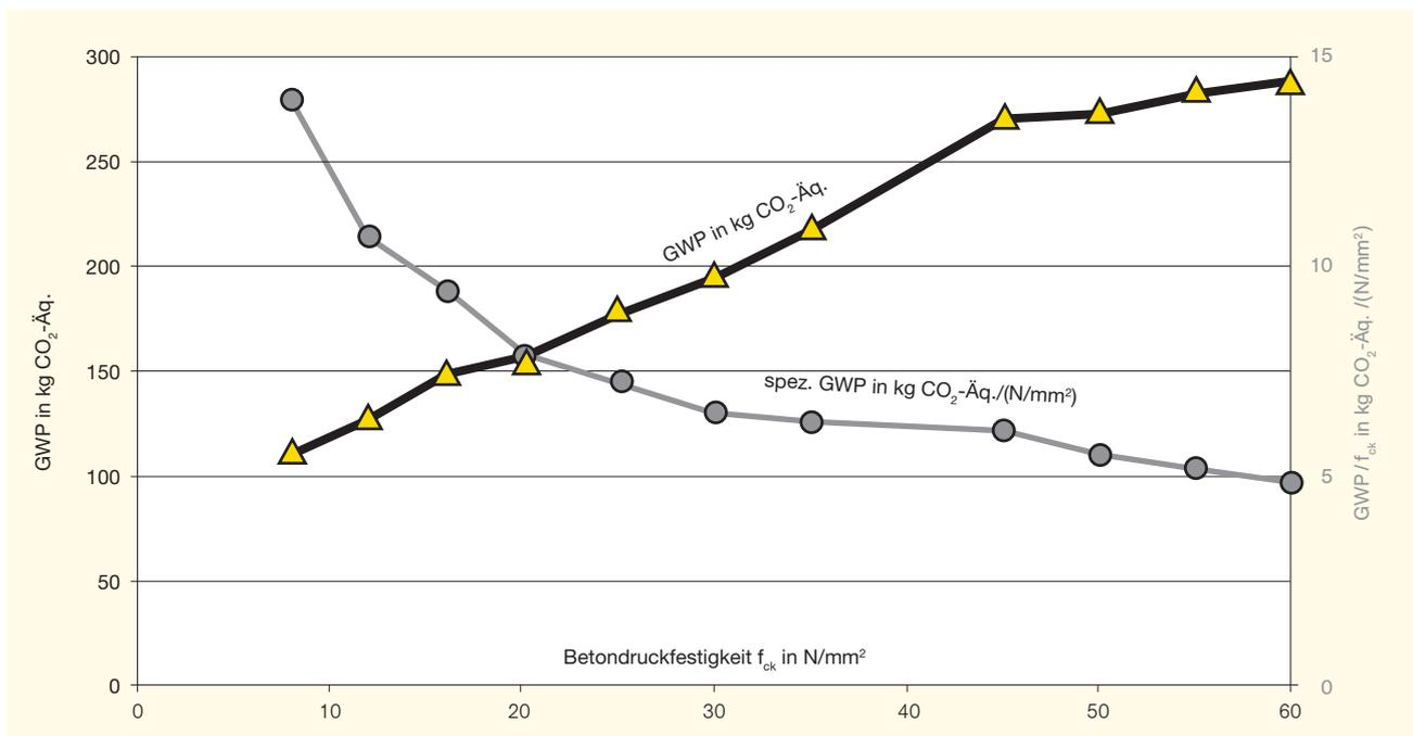
Abb. 18: Treibhauspotenzial (GWP) für die Herstellung (A1 bis A3) von 1 m³ Beton (schwarz) und bezogen auf die charakteristische Betondruckfestigkeit (grau)
