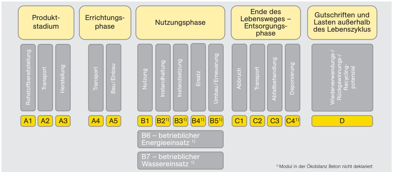
Abb. 5: Stadien des Lebensweges und Module für die Beschreibung und Bewertung eines Gebäudes; Abbildung nach Bild 1 in DIN EN 15804 [DIN3]
