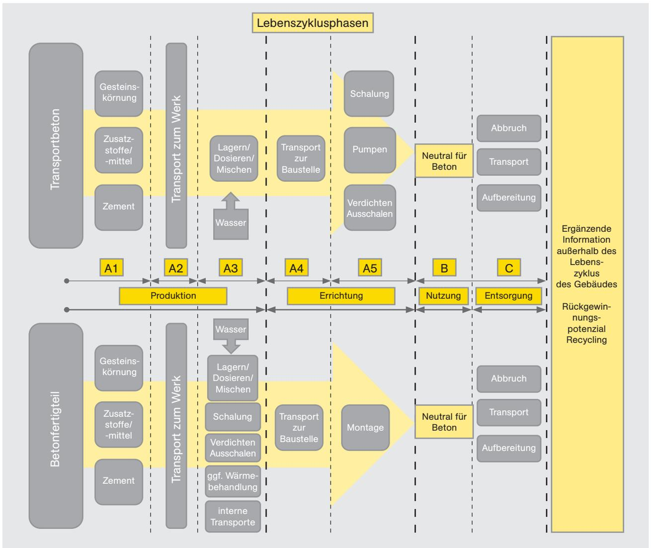
Abb. 6: Schema des Lebensweges eines Bauteils aus Beton mit Zuordnung zu den Modulen (in Anlehnung an DIN EN 15804)
