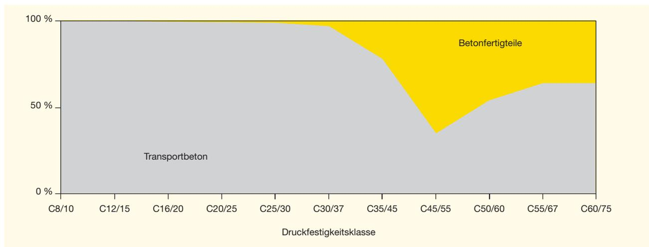
Abb. 3: Verhältnis der Produktionsmengen Transportbeton / Betonfertigteile (schematisch)
