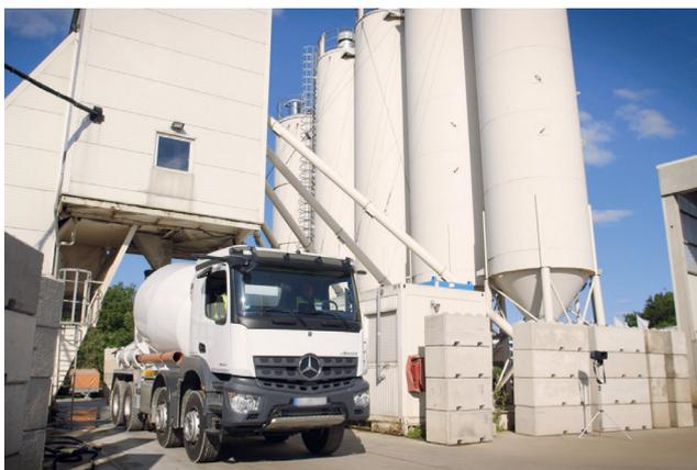
Abb. 9: Einfüllen des Frischbetons in den Fahrmixer
