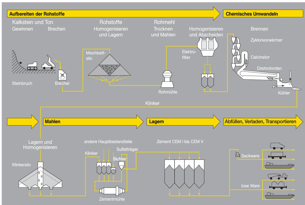
Abb. 8: Zementherstellung (schematisch)
