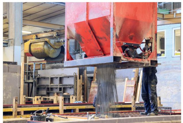
Abb. 10: Einbringen des Frischbetons im Fertigteilwerk
