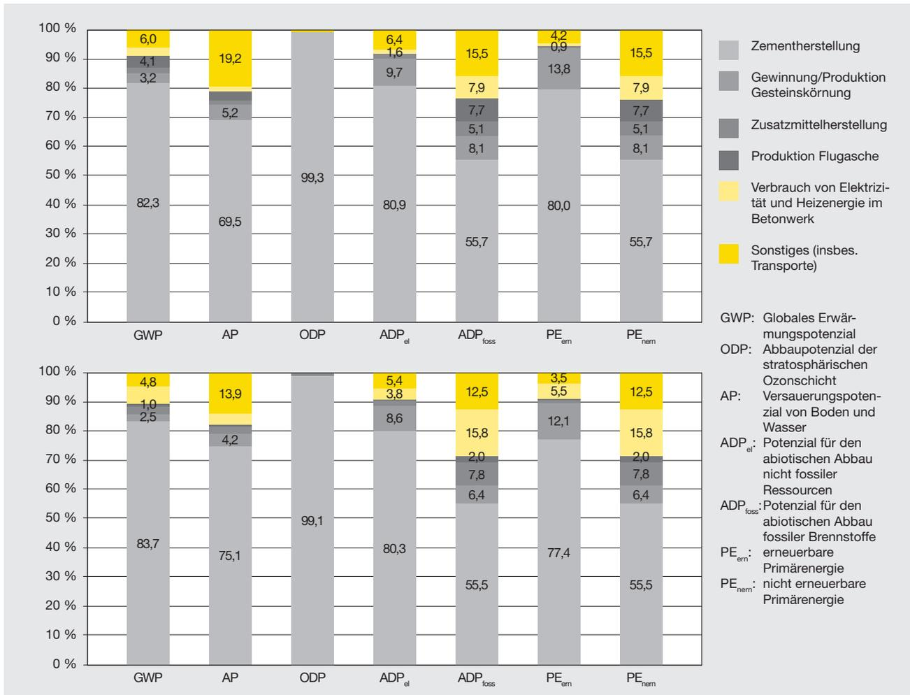
Abb. 17: Einflussfaktoren auf die Wirkungs- und Sachbilanz eines Betons der Druckfestigkeitsklasse C25/30 (oben) und C50/60 (unten) im Produktstadium (A1 bis A3)
